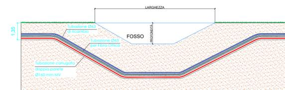
Particolare T.Attraversamento teleguidato Senza scala
