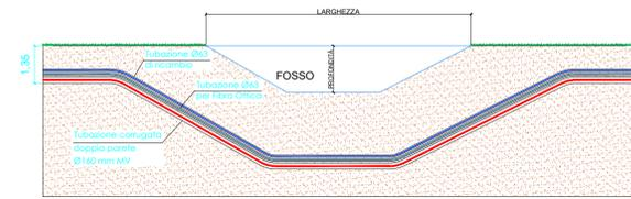
Particolare T Attraversamento teleguidato Senza scala
