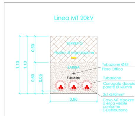
Particolari passaggio cavi di Media Tensione- scala 1:20
