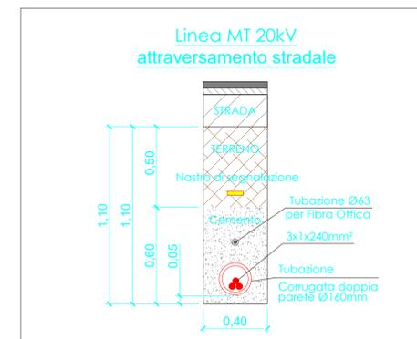
Particolari passaggio cavi di Media Tensione- scala 1:20
