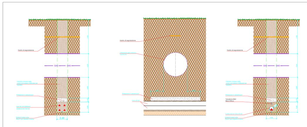
Particolare passaggio cavi MT/BT sotto il Metalonotito Scala:1:40
