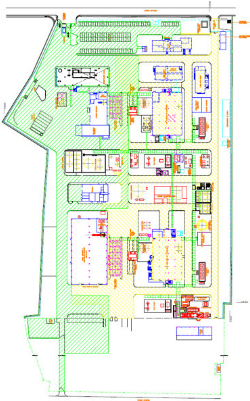
Figure 8 Pianta generale di Stabilimento in cui sono campite le superfici che raccolgono l'acqua meteorica non inquinata
