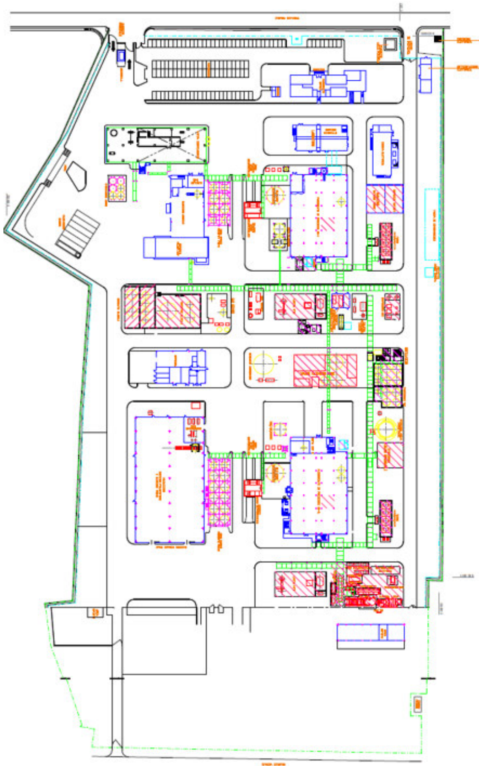
Figure 7 Pianta si Stabilimento in cui sono campite le superfici che raccolgono acqua potenzialmente inquinata, cioè le superfici escluse dal calcolo
