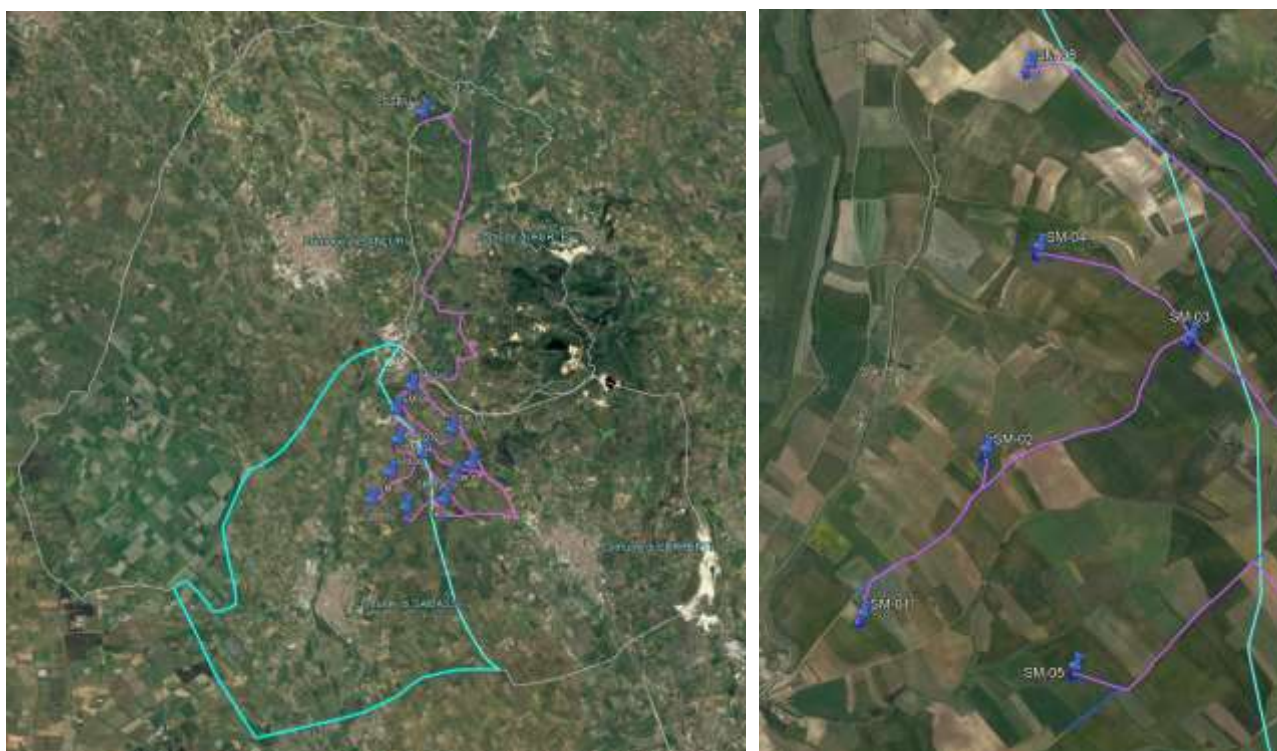
Figura 143 - Individuazione del layout di impianto rispetto al perimetro del territorio comunale di Samassi e particolare dell'ubicazione degli aerogeneratori e del tracciato cavidotti
