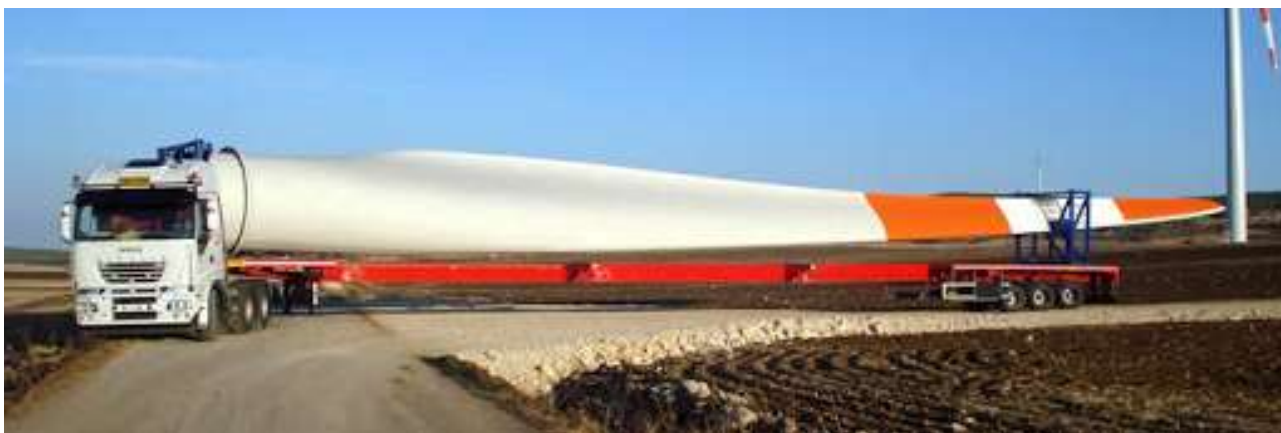
Figura 119 - Soluzione tipo del trasporto delle pale e pista di nuova realizzazione tipo per l'accesso alla turbina
