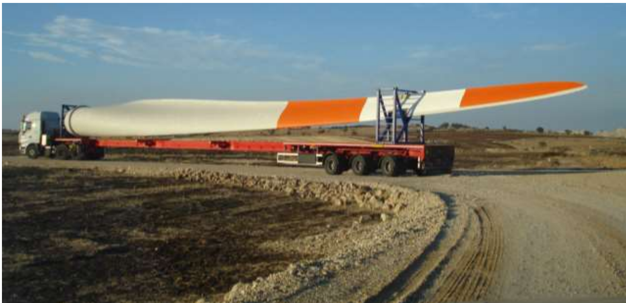
Figura 118 - Soluzione tipo del trasporto delle pale e adeguamento in curva tipo sulla viabilità esistente
