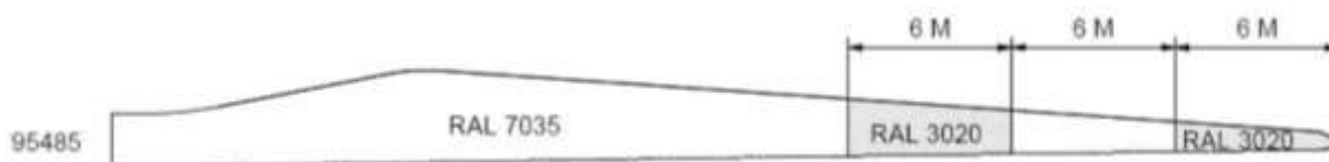
Figura 92 - Aerogeneratore tipo – Schema grafico delle proporzioni del colore delle pale
