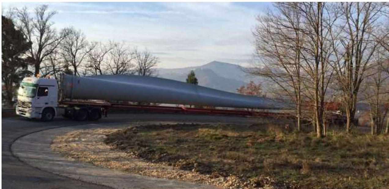
Figure 25 - Soluzione tipo del trasporto della pale e adeguamento in curva tipo sulla viabilità esistente
