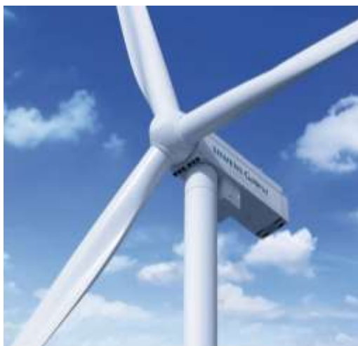
Figura 22 - Aerogeneratore Siemens-Gamesa tipo – Navicella che ospita il trasformatore
