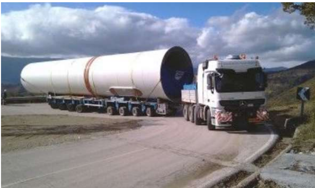
Figure 26 - Soluzione tipo del trasporto dei conici di torre e adeguamento in curva sulla viabilità esistente
