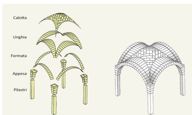
Figura 6. Schema di volta a spigolo o "a stella" a 4 punte. Tratto dal testo "Le volte leccesi tra tradizione e innovazione" di E. Arlati e L. Accoto.
