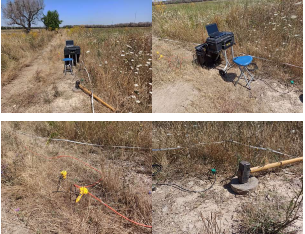
Tavola n. 16: Documentazione fotografica Indagini Sismiche Re.Mi.-MASW
