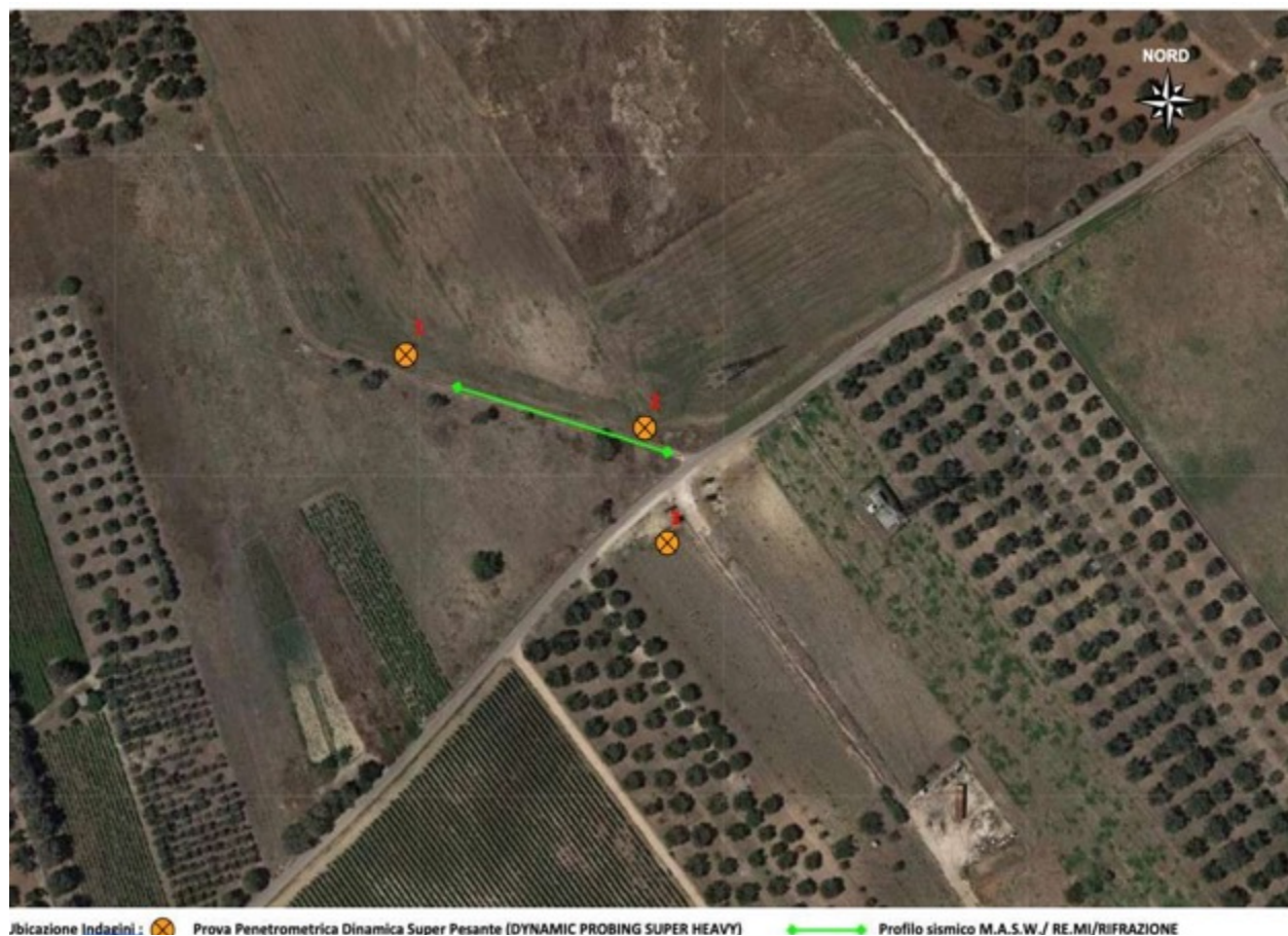
Tavola n. 13: ubicazione prove penetrometriche e profilo sismico.
