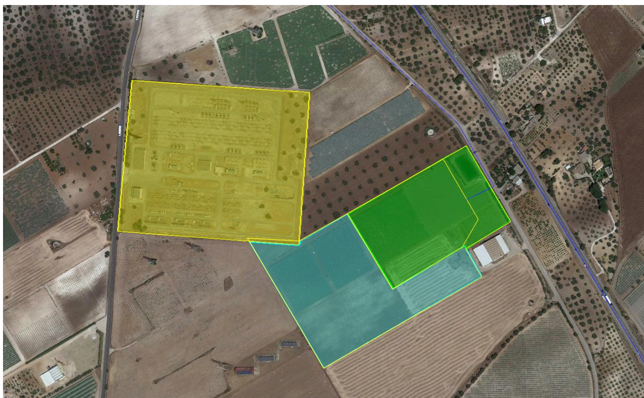
Figura 24 - Area destinata alla cabina utente e alla compensazione della potenza reattiva (in verde), Area di storage (in azzurro) e stazione TERNA prevista per la connessione alla rete elettrica ubicata in in c. da Pantaleo nel territorio comunale di Chiaramonte Gulfi (in giallo)
