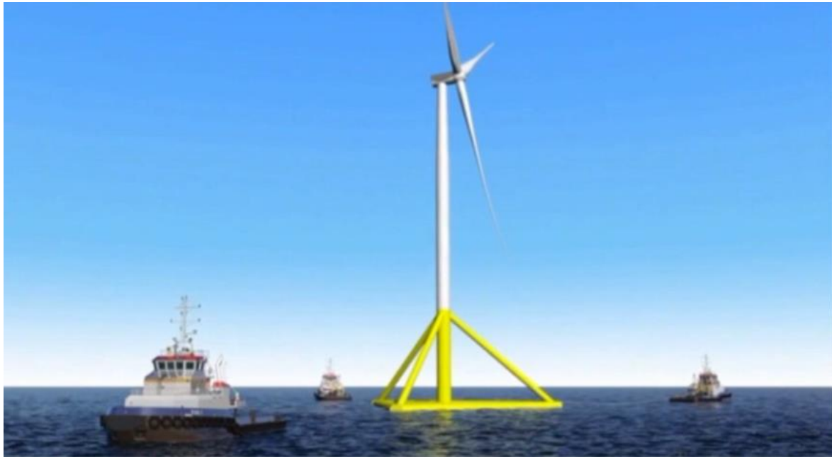
Figura 29 - Operazioni di rimorchio della turbina su piattaforma galleggiante
