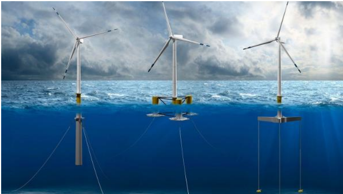
Figura 5 - Principali sistemi di ancoraggio
