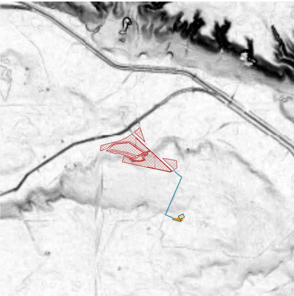
Fig. 5 - Carta "delle pendenze elaborata su base DEM - Aree con pendenze < del 10%
