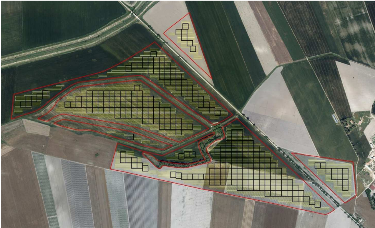
Fig. 7 - Area Impianto con maglie quadrate da 30*30 mt
