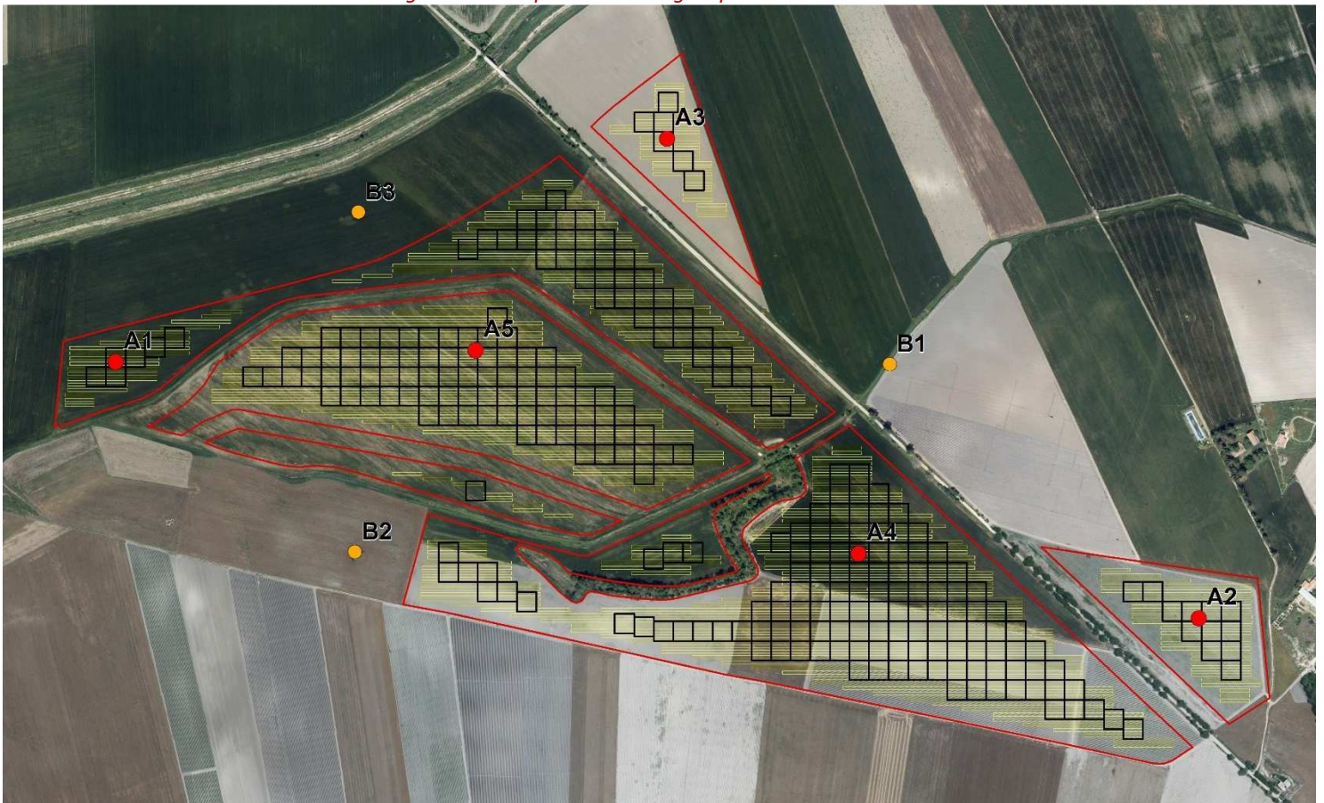
Fig. 8 - Area Impianto con i punti di campionare (verde=esterno ai moduli; rossi= sotto i moduli)
