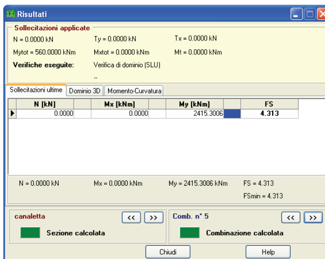
Figura 3.9: Verifica di resistenza COMB SISMICA - SLU
