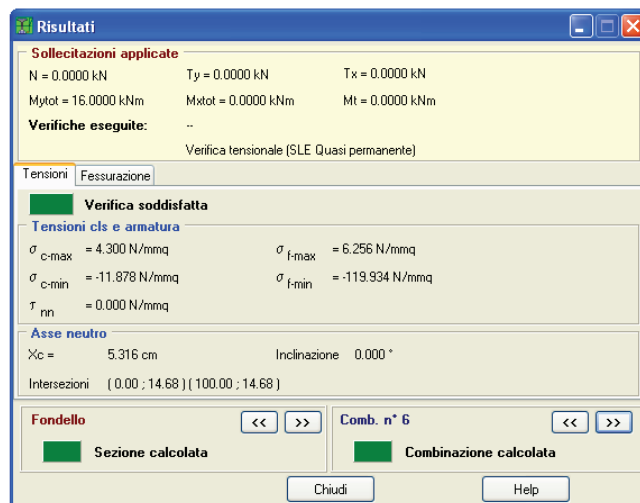
Figura 3.22: Verifica tensionale QUASI PERM - SLE
