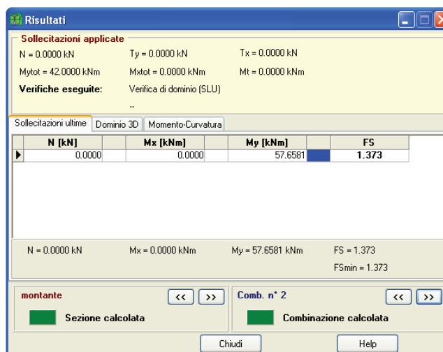
Figura 3.13: Verifica di resistenza COMB SISMICA - SLU
