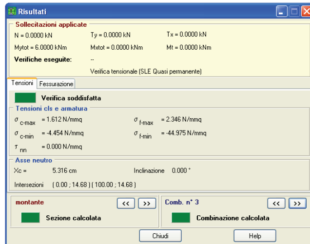
Figura 3.14: Verifica tensionale QUASI PERM - SLE
