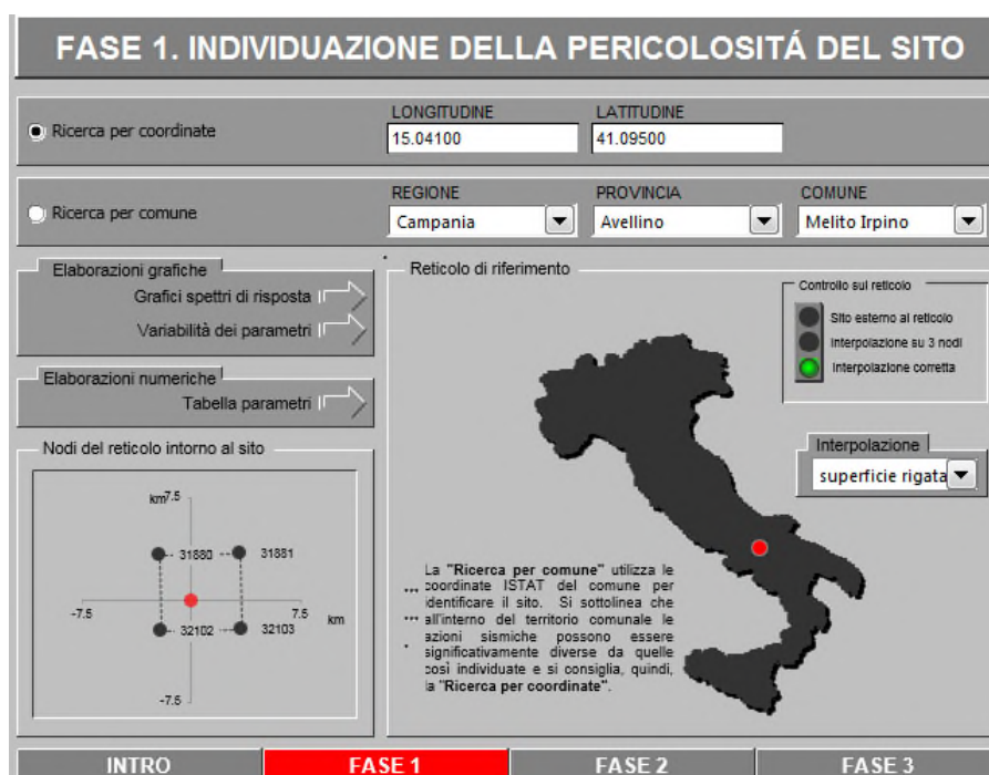
Figura 6.20 individuazione della pericolosità del sito
