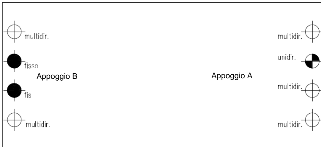
Figura 6.1 Schema degli appoggi degli impalcati
