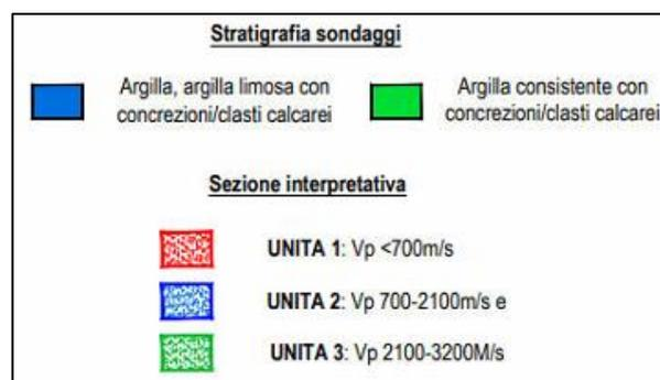
L'indagine geofisica eseguita con metodologia sismica a rifrazione ha permesso di identificare i range di velocità di propagazione delle onde di compressione che identificano le diverse unità sismostratigrafiche presenti nell'area di interesse. Tali valori di velocità risultano essere compresi tra 400 – 5500 m/sec.
