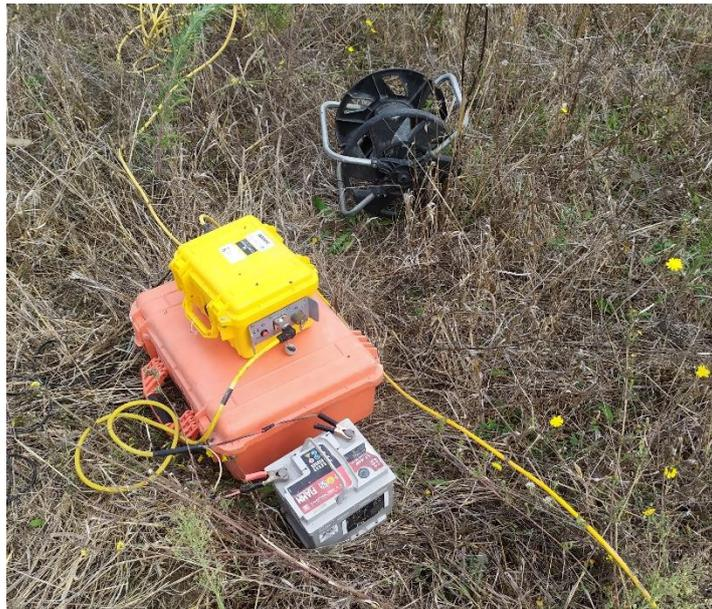
*Strumentazione indagine sismica*
