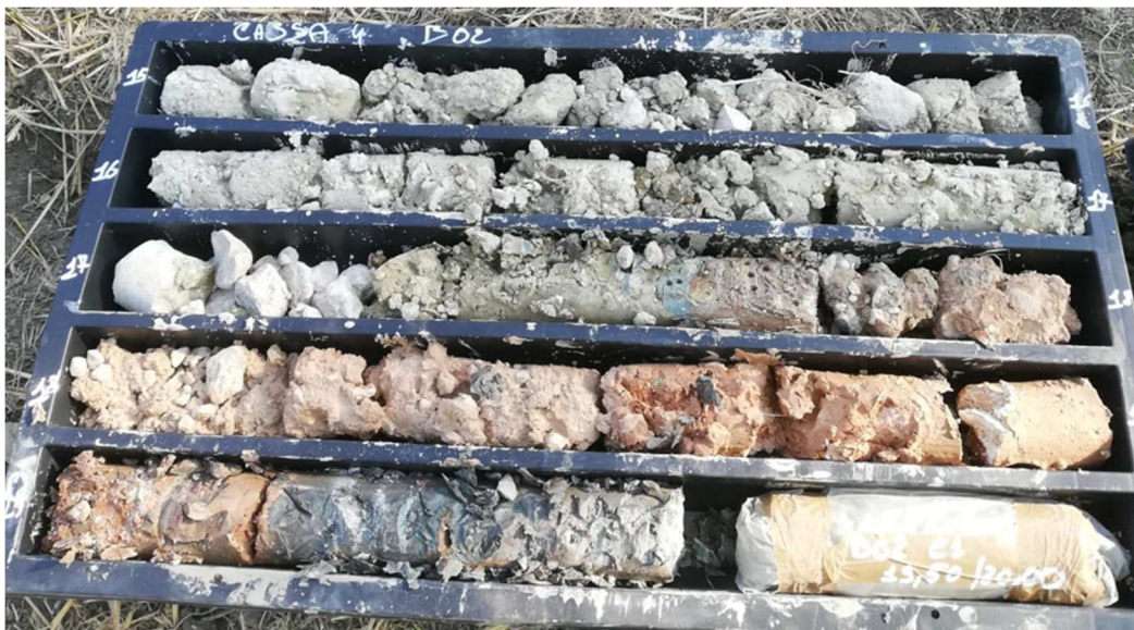
Figura 8-3 – Cassetta di sondaggio IN21-B02 – Unità FYR – corpo di frana
