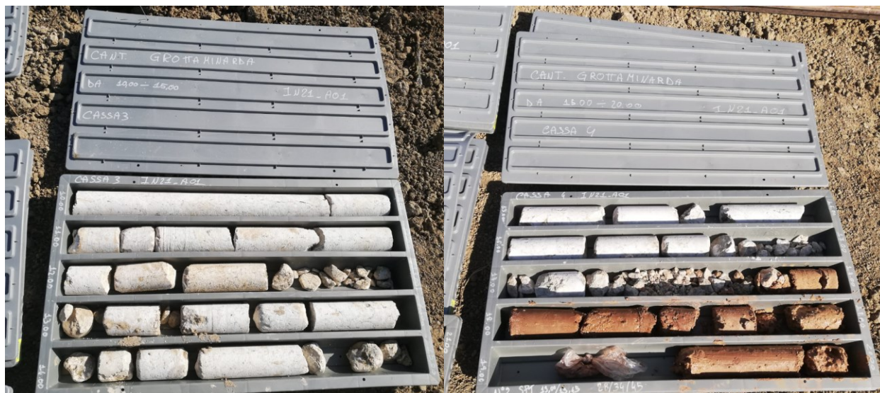
Figura 2-45 – Foto cassette sondaggio IN21-A01 – a sinistra elementi calcareo-calcarenitici in matrice argilloso limosa (destra)
