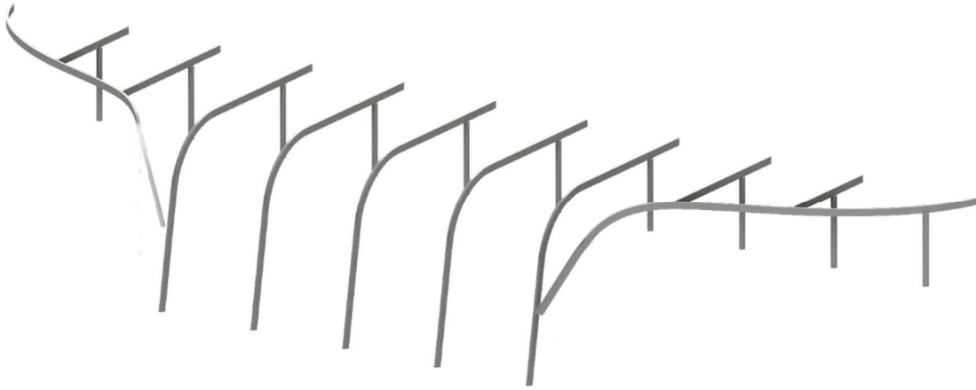
Figura 42 – Schema struttura portante della pensilina
