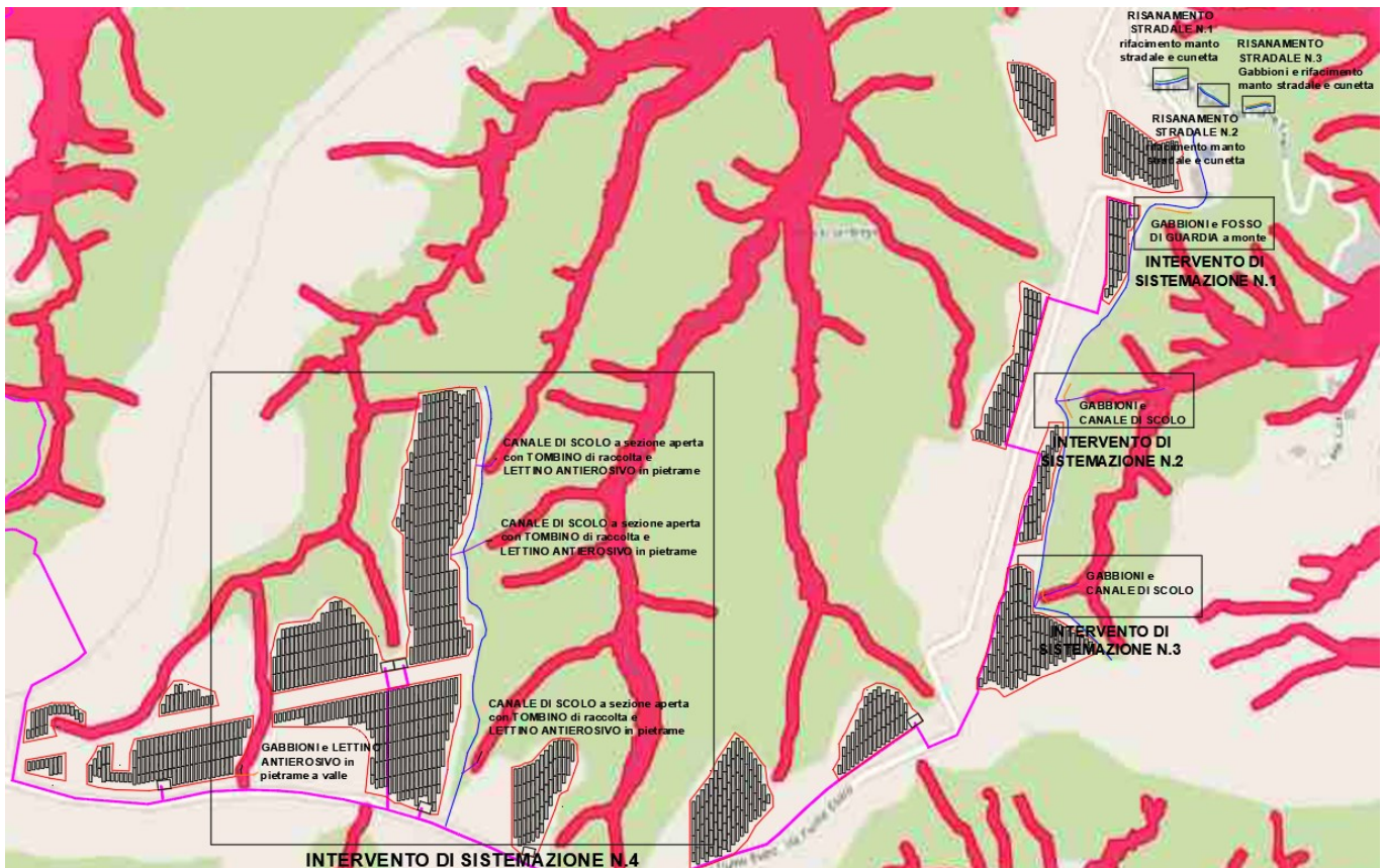
Figura 32: Distanza delle opere di mitigazione dalle aree del Piano Stralcio PAI – Pericolo idraulico
