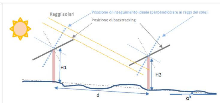
Figura 46: Funzionamento del backtracking
