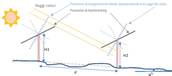
Figura 41: Funzionamento del backtracking
