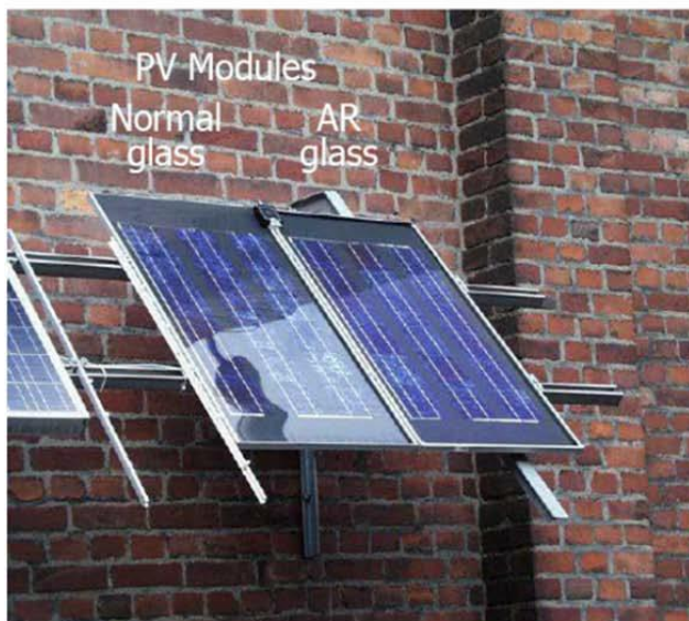
Figura 2 - Le due immagini dimostrano come, al contrario di un vetro comune, il vetro anti-riflesso (Anti-Reflecting glass) che riveste i moduli fotovoltaici riduca drasticamente la riflessione dei raggi luminosi
