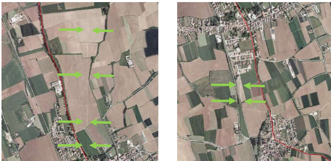
In verde l'ingombro della “carreggiata” della via Iulia Augusta. In rosso il percorso del cavidotto.
