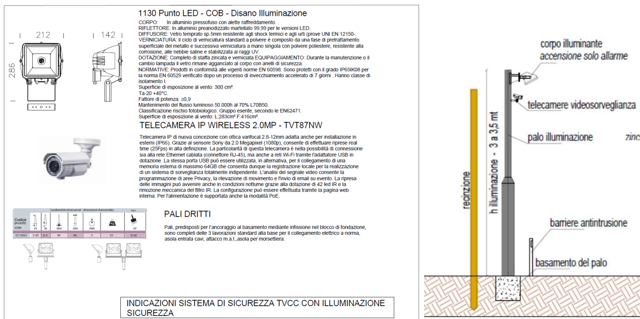
Figura 14 – Componenti sistema di Illuminazione
