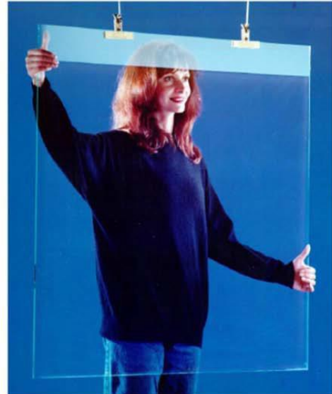
Figura 2. Le due immagini dimostrano come, al contrario di un vetro comune, il vetro anti-riflesso ( Anti-Reflecting glass ) che riveste i moduli fotovoltaici riduca drasticamente la riflessione dei raggi luminosi
