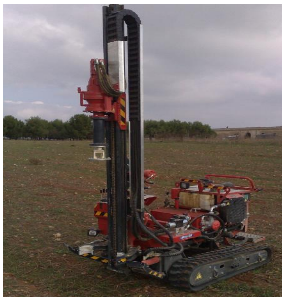
FIGURA 19 - MACCHINA BATTIPALO PER INFIESSIONE PALI.
