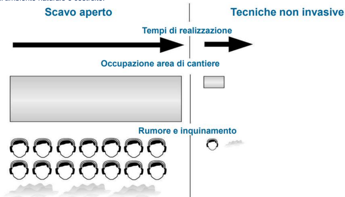
Figura 3 - confronto tra scavo aperto e tecniche non invasive
