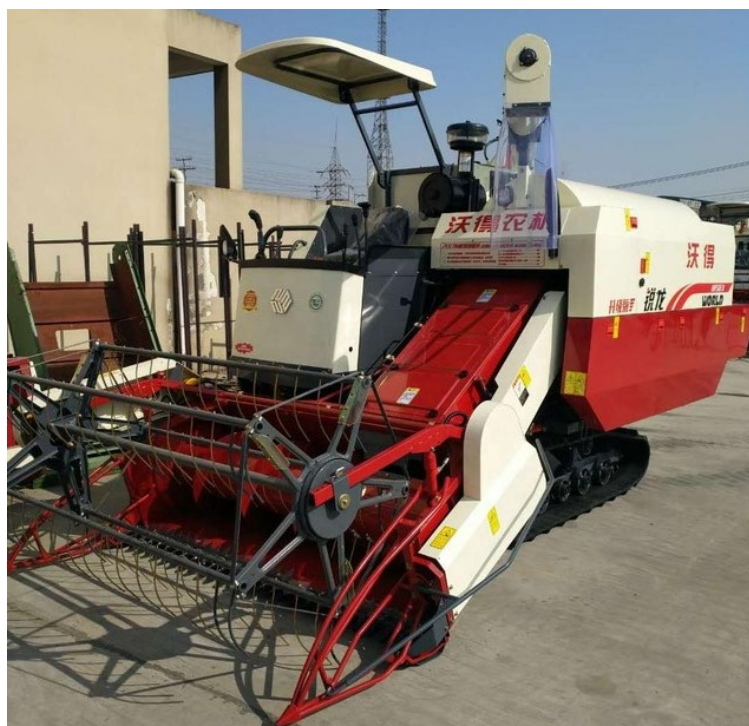
60- esempio di minitrebbia: la larghezza di lavoro risulta perfettamente adattabile al contesto in cui si opera
