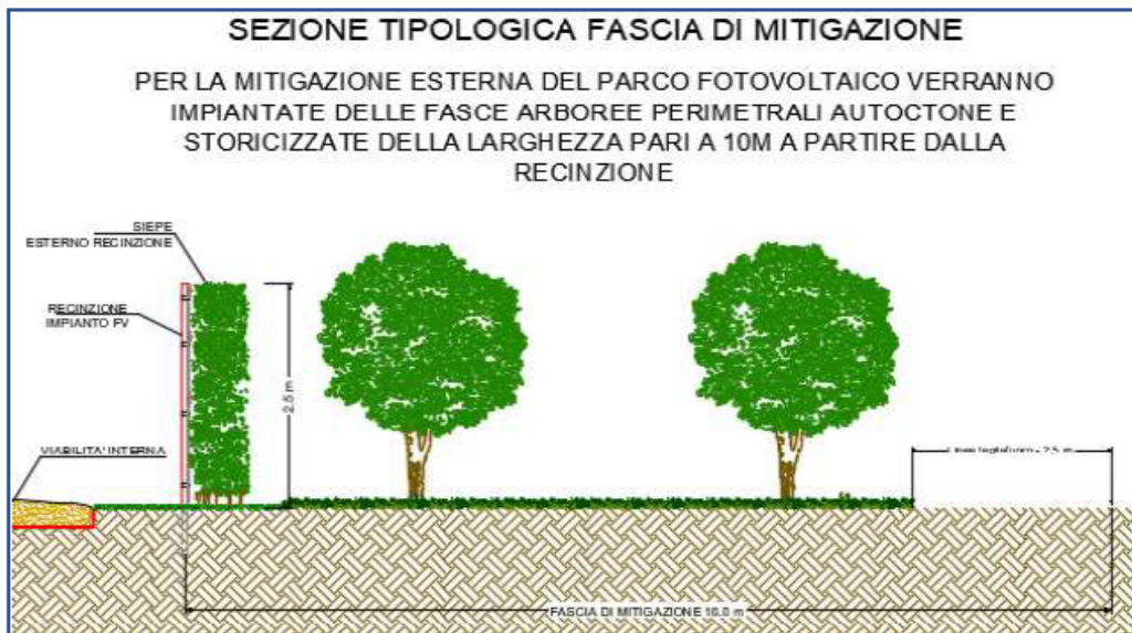
62 - Sezione tipologica fascia di mitigazione perimetrale
