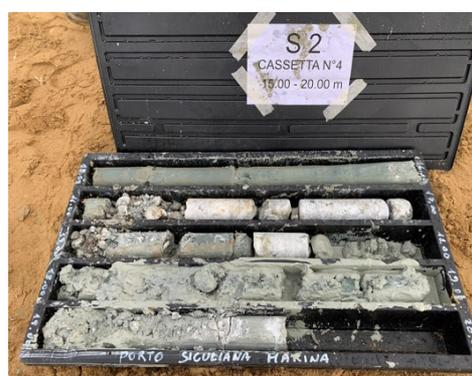
Figure 22- Campioni di sedimento del sondaggio S2 da 5 a m 20
