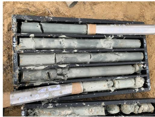
Fig. 21 - Campioni di sedimento del sondaggio S1 da 5 a m 20
