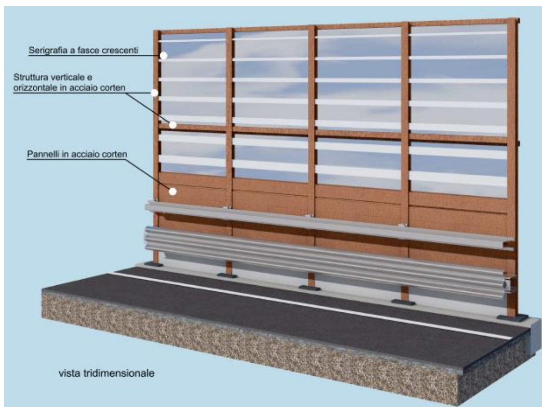
Figura 14: Render barriera integrata antirumore con i primi 2 metri ciechi
