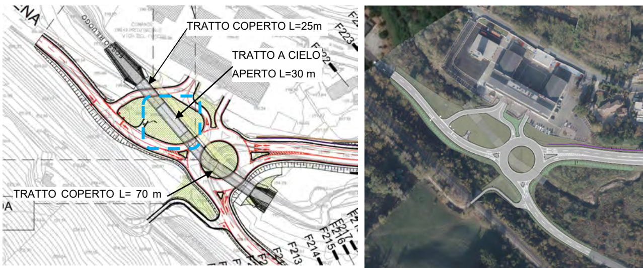
Nuovo manufatto scatolare sul Torrente Riluogo per risoluzione della criticità idraulica in zona Vigili del Fuoco (nel riquadro blu della figura a sx il tratto di 30 metri circa a cielo aperto)
