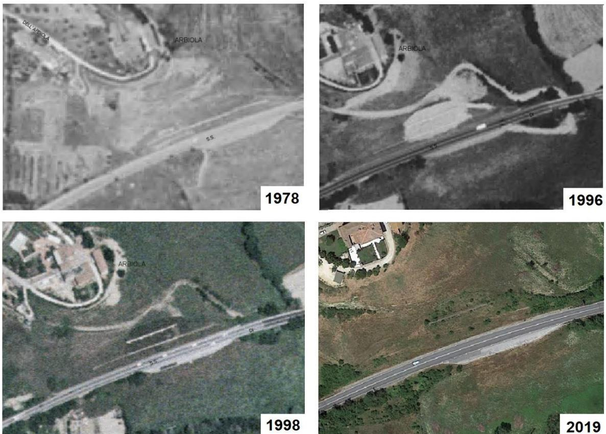
**Figura 16 - Evoluzione temporale negli ultimi decenni della scarpata a monte del tracciato tra l'imbocco est della galleria San Lazzero e il Viadotto Luglie**
