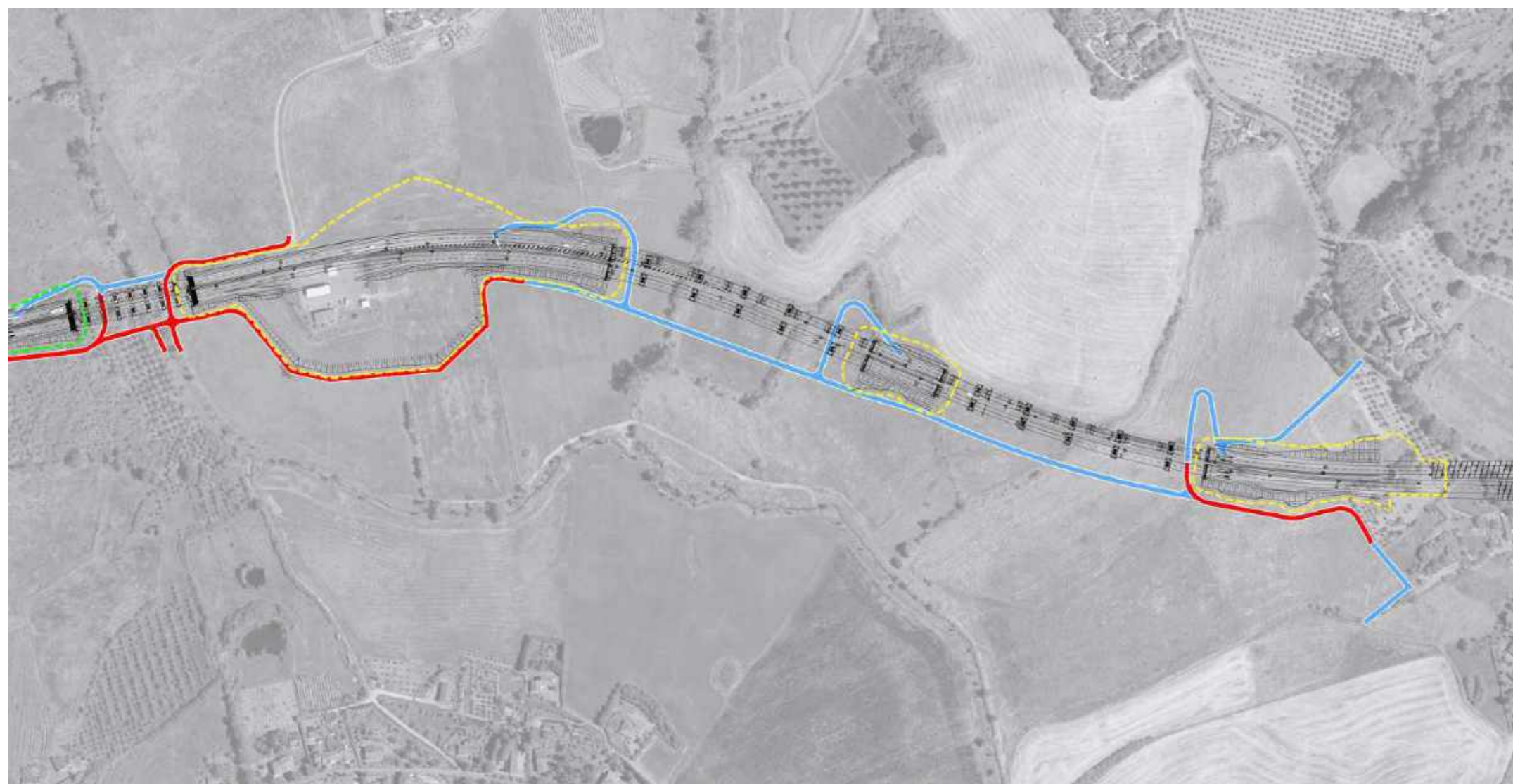
Strade di cantiere realizzate nella zona di Coroncina. In colore rosso le piste mantenute come nuova viabilità poderale realizzate secondo le Norme Tecniche di Attuazione del Piano Operativo del Comune di Siena.
