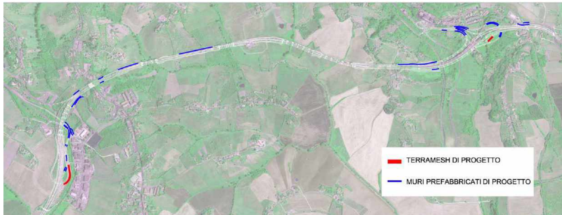
Planimetria di individuazione opere di sostegno (muri prefabbricati e terramesh). Codice elaborato: T00IA02AMBDI03B.
