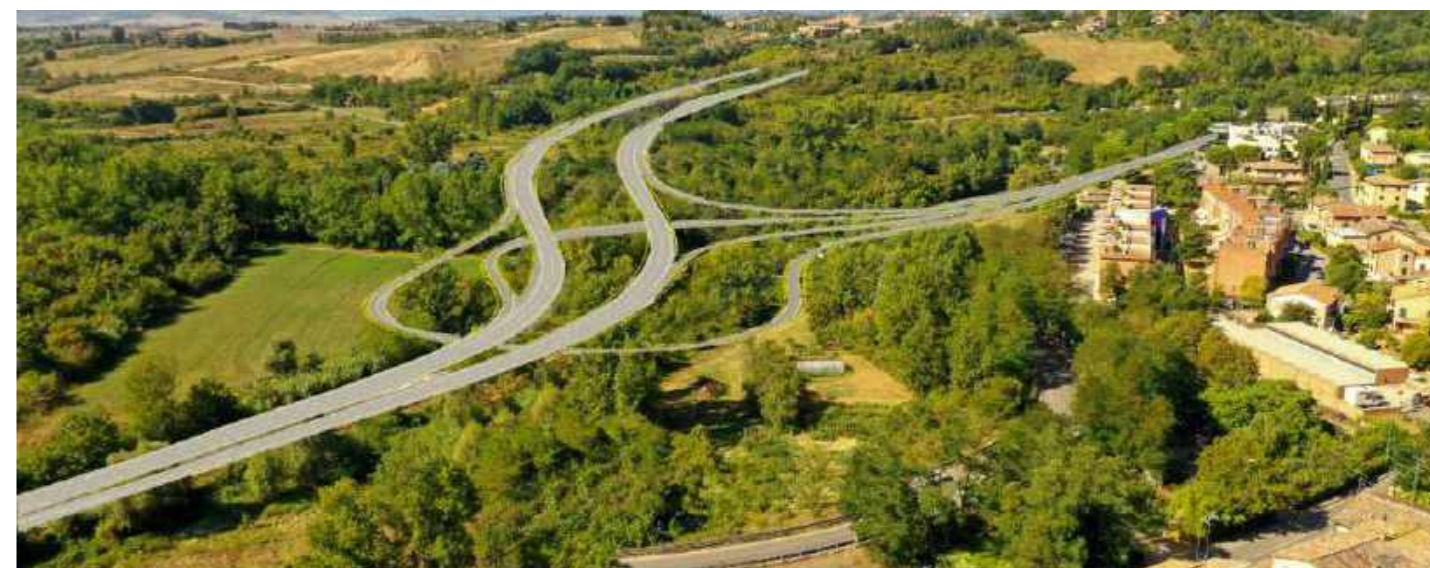
Ripresa aerea dello Svincolo Ruffolo. Nell'immagine in alto la sovrapposizione del tracciato dell'alternativa di progetto.
