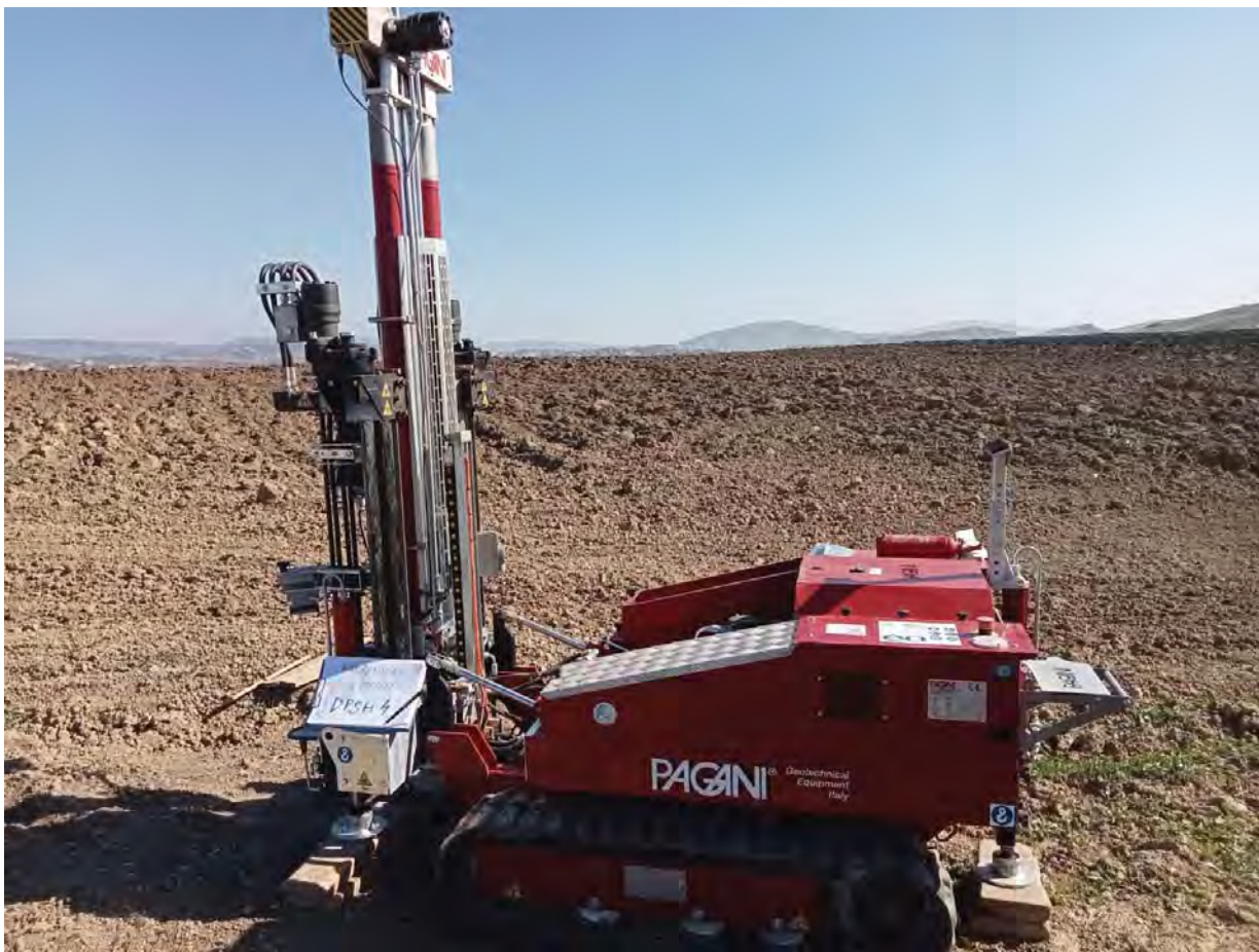
Prova penetrometrica DINAMICA DPSH04
