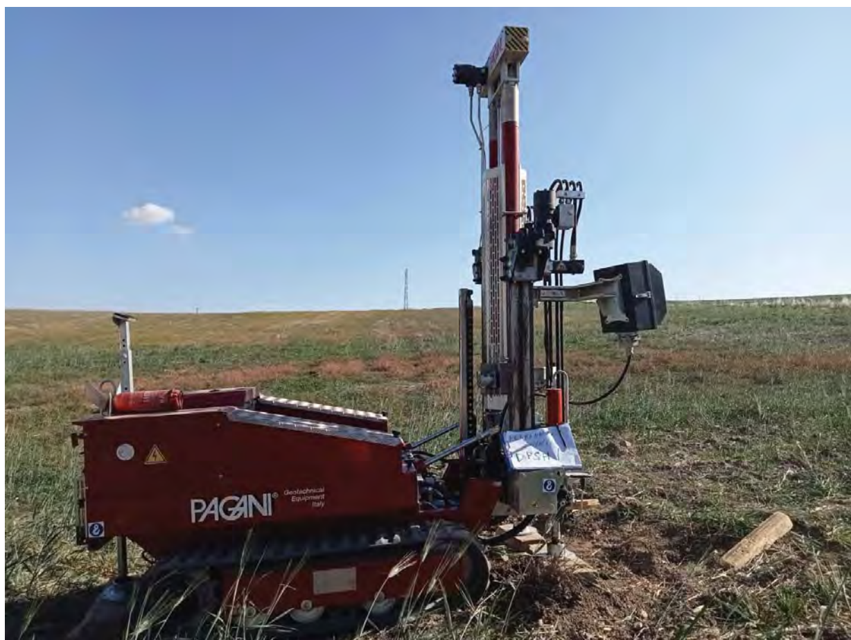
Prova penetrometrica DINAMICA DPSH01
