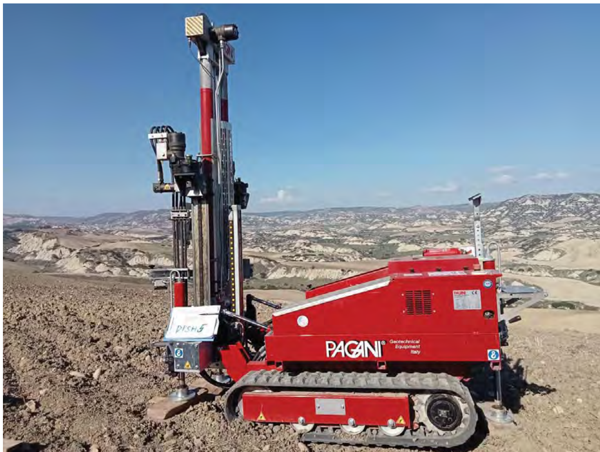
Prova penetrometrica DINAMICA DPSH05
