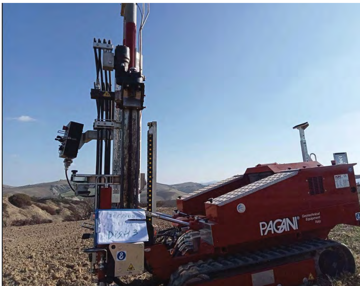
Prova penetrometrica DINAMICA DPSH03
