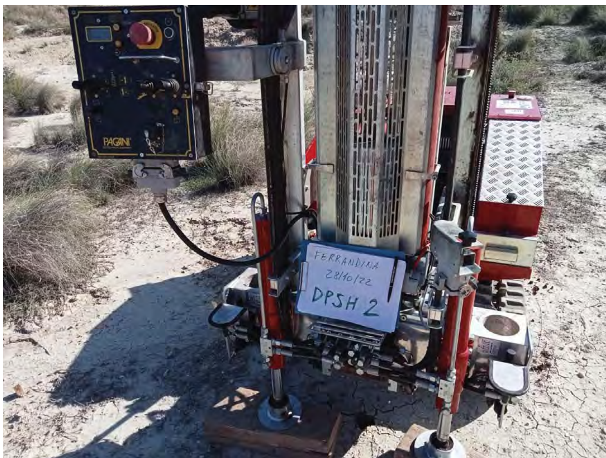
Prova penetrometrica DINAMICA DPSH02
