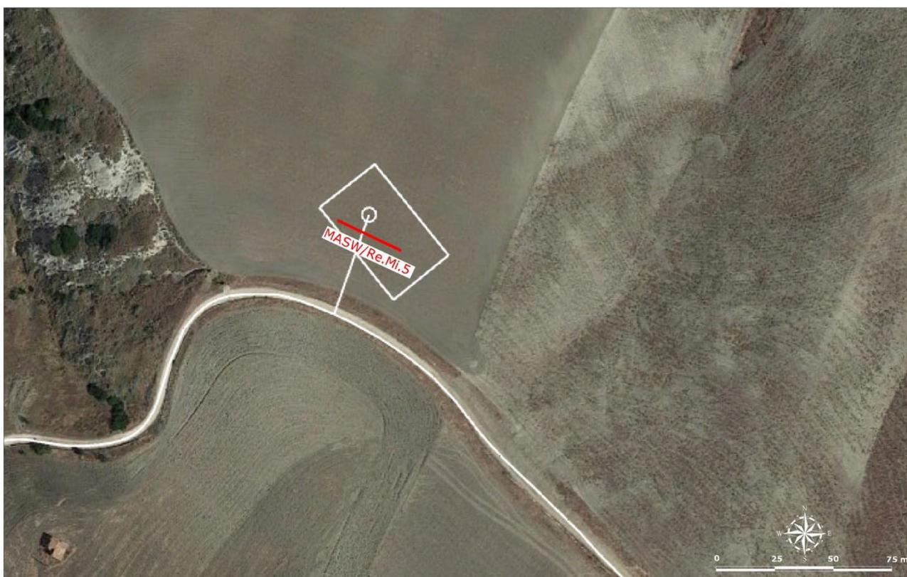
LEGENDA: MASW/Re.Mi. Prospezione sismica MASW e Re.Mi.
