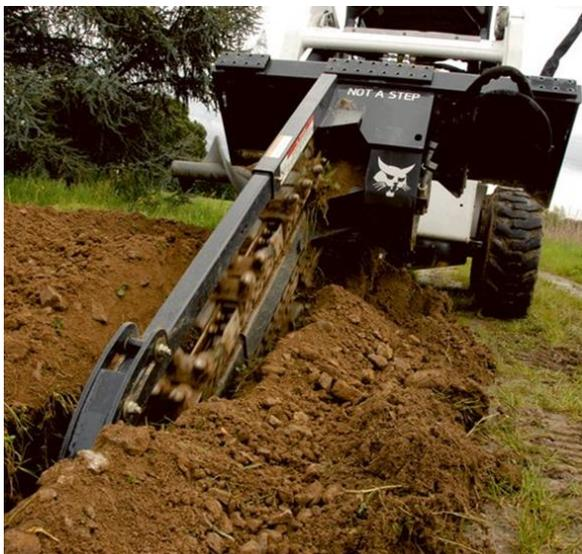
quelli delle trincee in cui posare il cavidotto. Nel dettaglio, saranno eseguite microtrincee tramite un'apposita attrezzatura "trencher" (rif. figura laterale) che riduce sia i volumi di scavo che i tempi di realizzazione. Nei terreni di che trattasi sono stimati scavi di lunghezza di oltre un chilometro al giorno.
