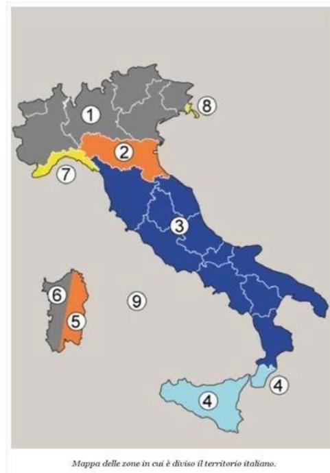
La velocità di riferimento per il calcolo della pressione cinetica, è stata calcolata per un periodo di riferimento TR pari a 30 anni (si veda la circolare 2 febbraio 2009, n.617). Di seguito sono riportate le grandezze coinvolte nel calcolo dell'azione dovuta al vento:
