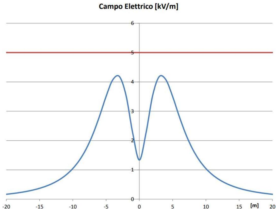
Figura 9: Campo elettrico al suolo generato dal sistema di sbarre a 220 kV
