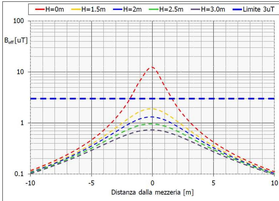
Figura 7: Andamento dell'induzione magnetica prodotta dalla linea in cavo per la massima corrente dell'impianto
