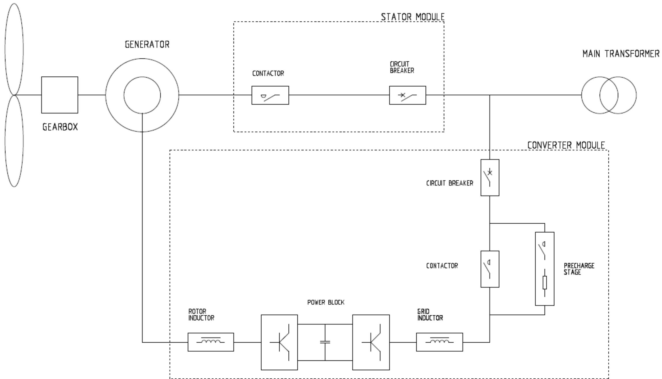
Schema funzionale tipo Aerogeneratore SG 170
