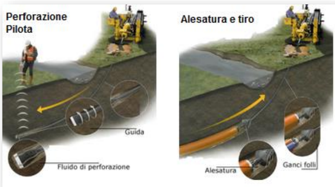
Figura 44 - tecnologia di trivellazione orizzontale controllata (TOC)
