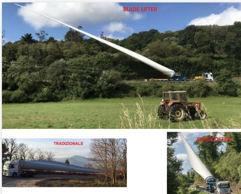
Figura 30 – esempi di trasporto tradizionale e soluzione con cambio della configurazione di carico durante il percorso (blade lifter)
