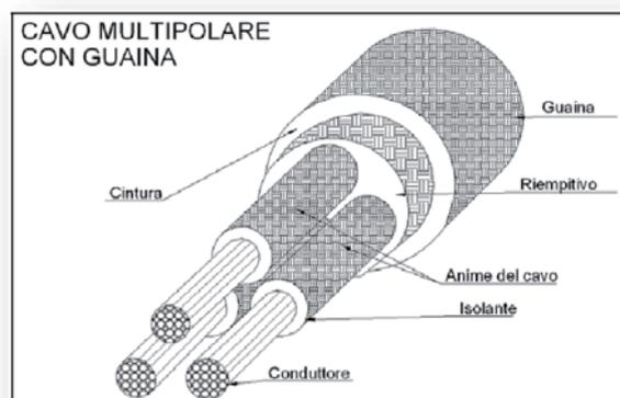
Figura 1 - Cavo multipolare con guaina.
