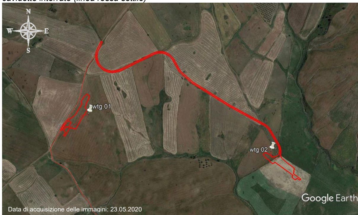
Figura B – Particolare della Fig. A con indicate la posizione degli aerogeneratori WTG 01 e 02 in progetto (segnaposto bianchi), le relative aree di cantiere (poligoni rossi), il percorso della nuova viabilità di accesso ai singoli aerogeneratori (linea rossa doppia) e il percorso del cavidotto interrato (linea rossa sottile)
