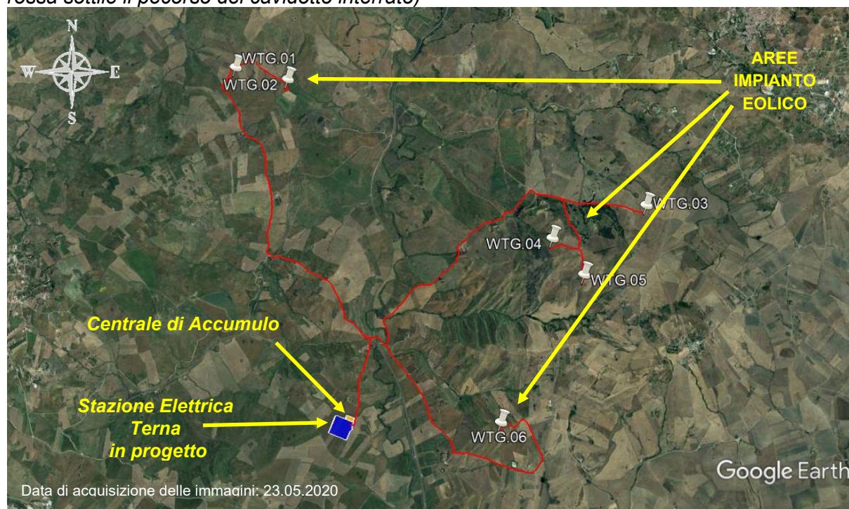
Figura A - Individuazione generale del Parco Eolico denominato "Astra" (i segnaposto bianchi indicano la posizione degli aerogeneratori in progetto - identificati da un codice mentre la linea rossa sottile il percorso del cavidotto interrato)
