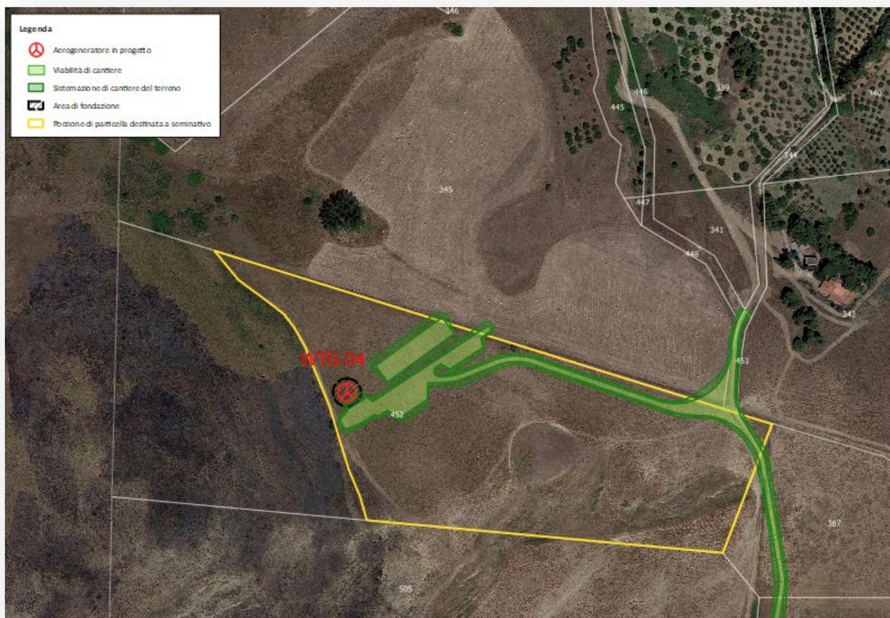
**Figura 19 – Sovrapposizione opere in progetto rispetto alla zona percorsa dal fuoco**
