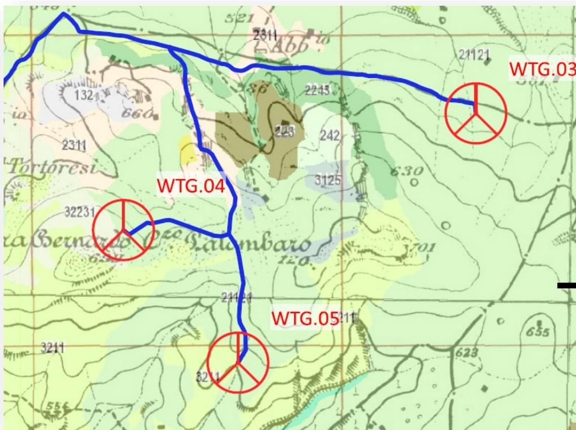
Figura 15 – Sovrapposizione opere in progetto con carta uso del suolo
