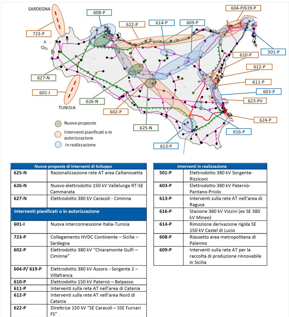
Figura 7 – Interventi di sviluppo della rete di Trasmissione Nazionale nella Regione Siciliana (Fonte:Terna s.p.a.)
