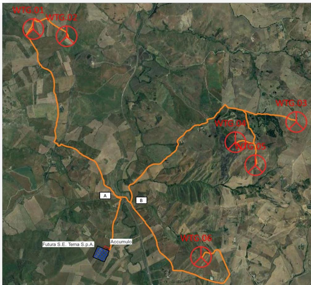
*Figura 3 - Percorso dell'elettrodotto interrato*
