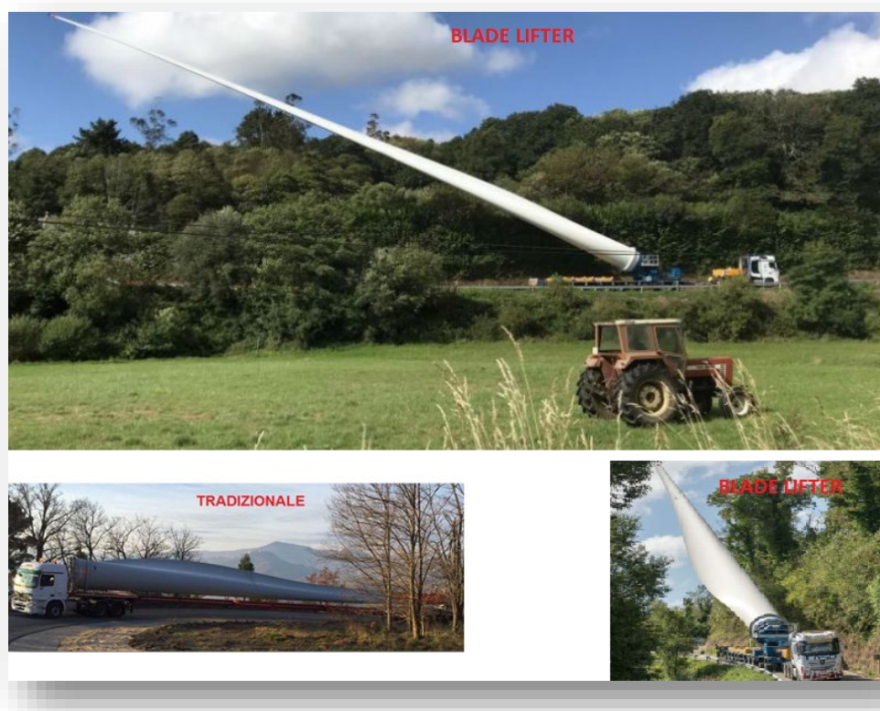
Figura 20 – esempi di trasporto tradizionale e soluzione con cambio della configurazione di carico durante il percorso (blade lifter)
