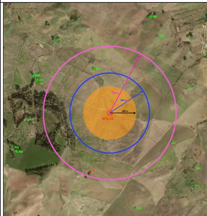
Figura 8 - Estratto elaborato n. EDP0033 (Verifica delle distanze minime dell'impianto dai fabbricati WTG_03)
