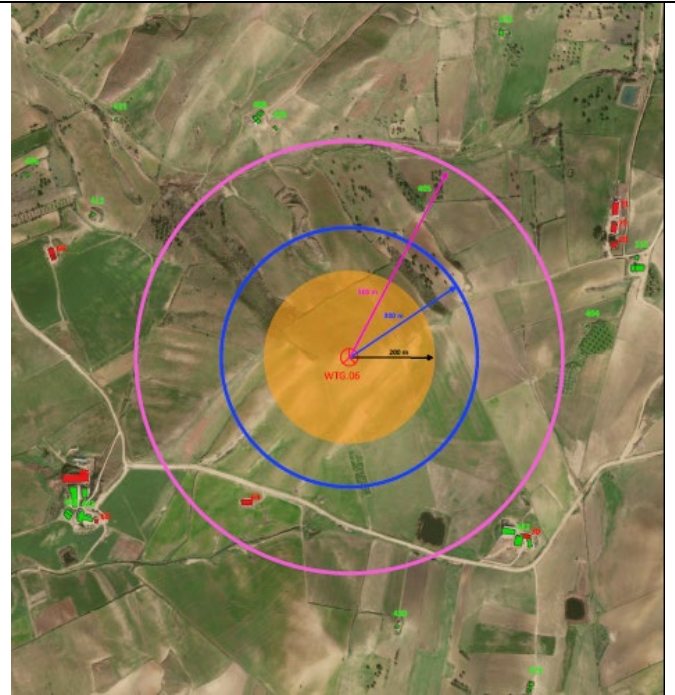
Figura 11 - Estratto elaborato n. EDP0036 (Verifica delle distanze minime dell'impianto dai fabbricati WTG_06)
