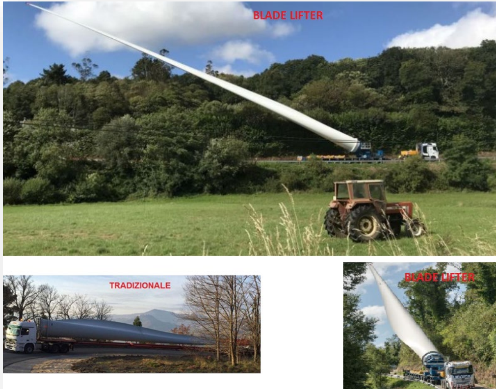
Figura 23 – esempi di trasporto tradizionale e soluzione con cambio della configurazione di carico durante il percorso (blade lifter)
