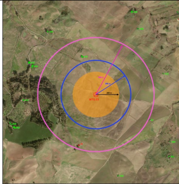
Figura 11 - Estratto elaborato n. EDP0033 (Verifica delle distanze minime dell'impianto dai fabbricati WTG_03)
