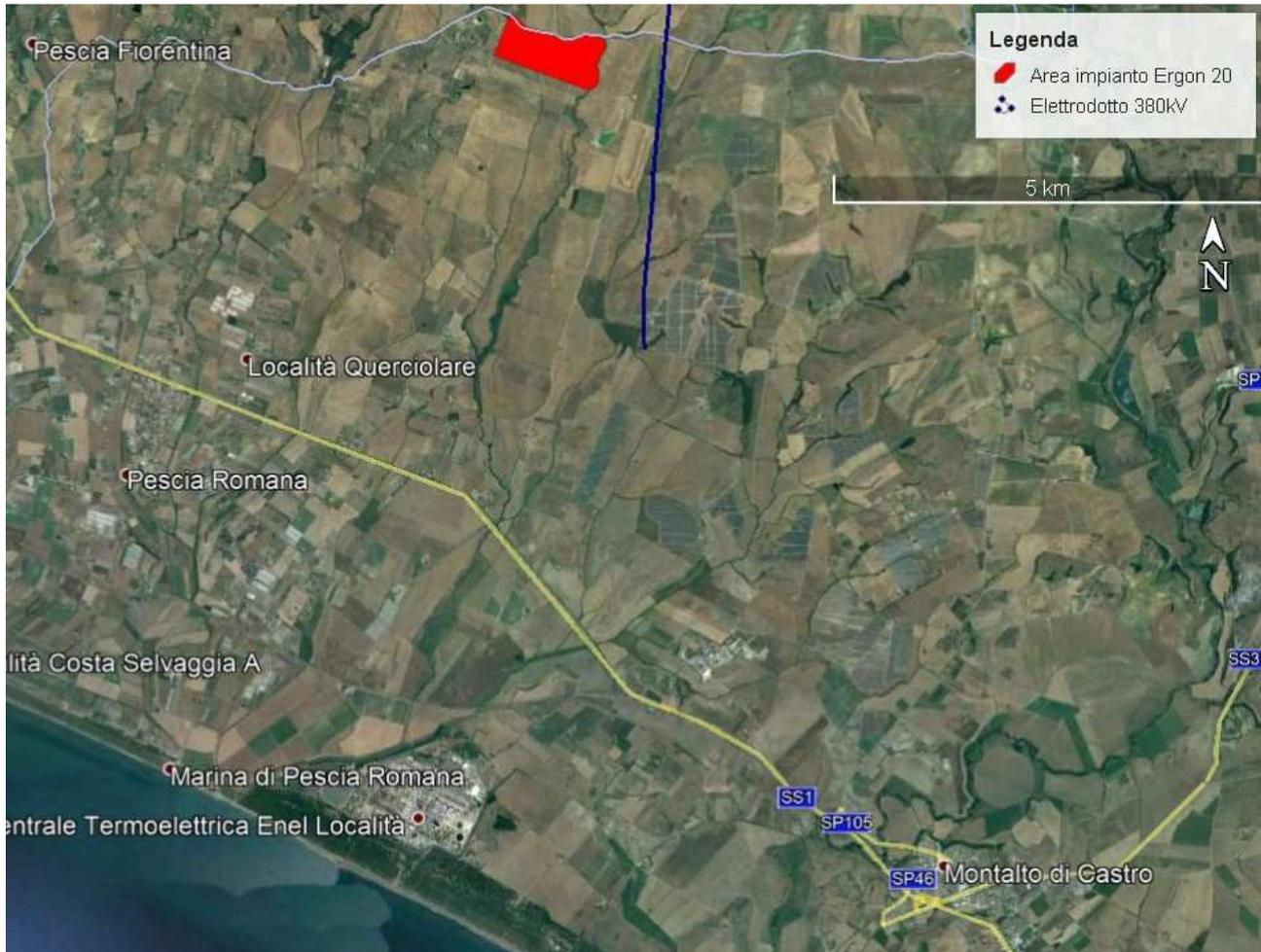
Nell'immagine satellitare di cui sopra l'area occupata dall'impianto fotovoltaico è evidenziata in rosso, mentre in blu si è evidenziato il tracciato dell'elettrodotto 380kV Suvereto-Montalto individuato come punto di connessione alla rete RTN secondo quanto specificato nella Soluzione Tecnica Minima Generale messa a disposizione da Terna S.p.A.
