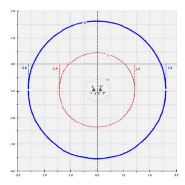
Si può quindi considerare che l'ampiezza della fascia di rispetto sia pari a 3 m, a cavallo dell'asse del cavidotto. Infine, poiché in un cavo schermato il campo elettrico esterno allo schermo è nullo, non è rappresentato il calcolo del campo elettrico prodotto dalla linea in oggetto.
