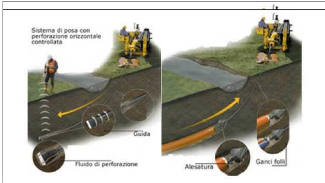
Fig. 9: Tecnica di Scavo TOC.
