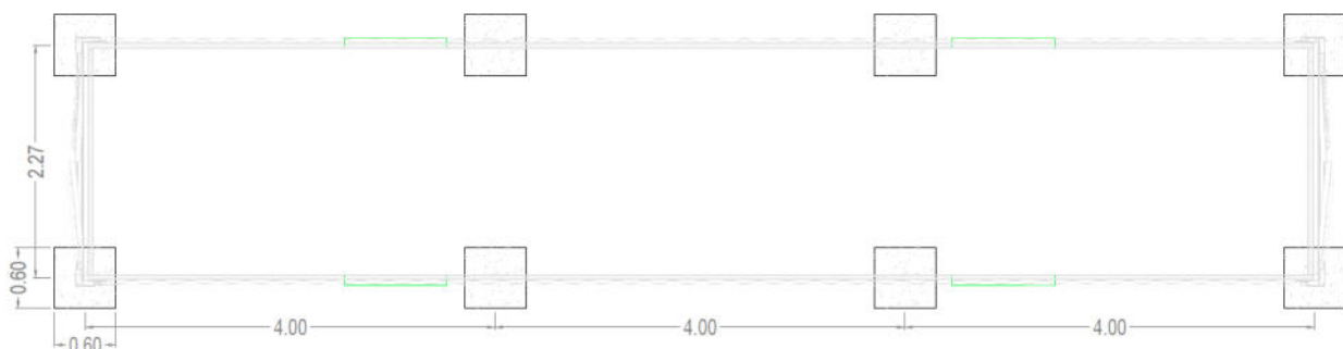
Fig. 3.2.17 – Schema planimetrico di fondazione delle cabine di smistamento e magazzino
