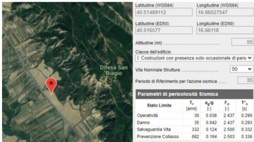
Fig. 4.1.8 - Parametri di pericolosità sismica dell'area di progetto nel Comune di Montescaglioso (Fonte: Relazione geologica)
