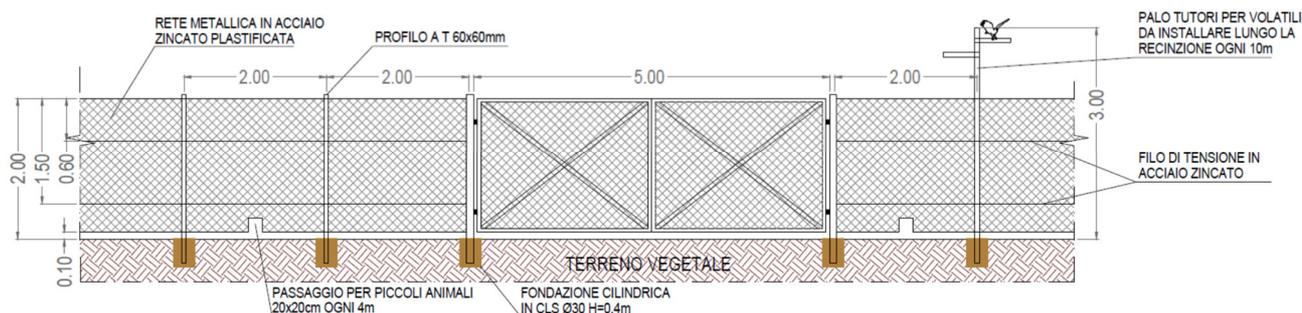
**Fig. 3.11 - Particolare dell'ingresso carrabile e della recinzione**
