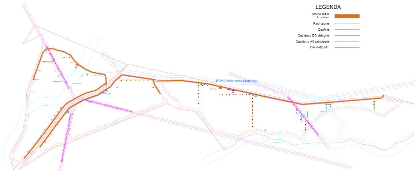
Fig. 3.3 - Schema dei cavidotti MT di campo su base catastale
