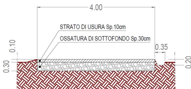
**Fig. 3.12 - Sezione di dettaglio della strada interna**
