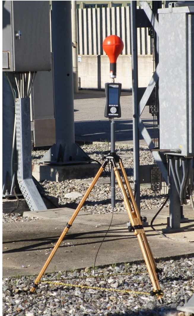
Figura 6.3.3 – Immagini dello strumento per la misura del campo elettrico
