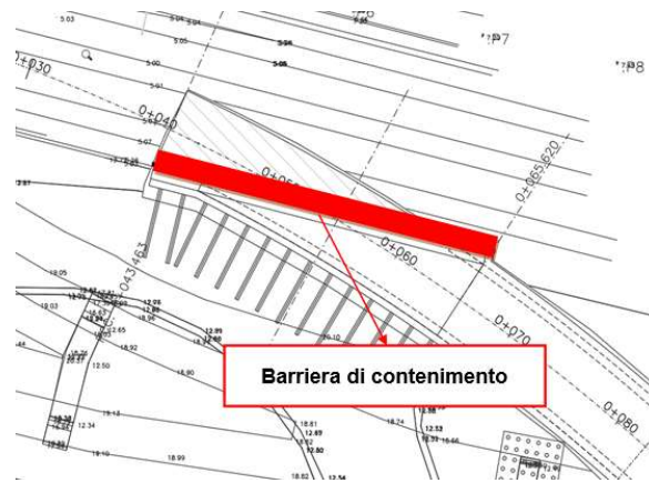
Figure 11-11: Barriera di contenimento – disposizione planimetrica
