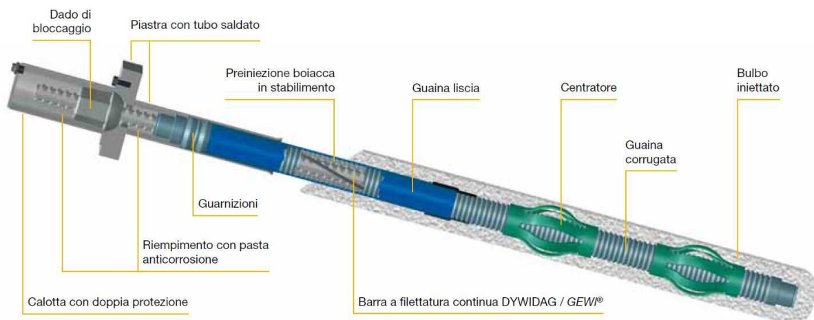
Figura 1: Spaccato dell'ancoraggio a doppia protezione anticorrosione (DCP)
