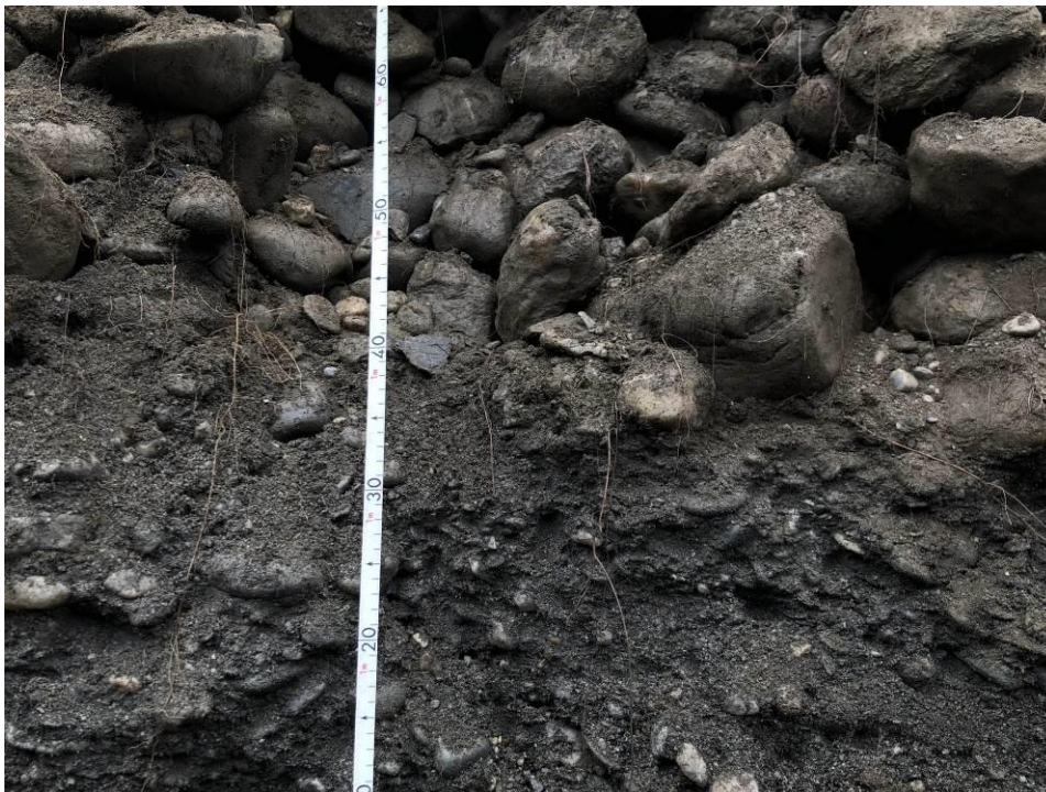
Figura 17 - Rilievo pedologico: particolare della transizione a 1,2 m dal piano campagna (1,4 m dalla falda affiorante).
