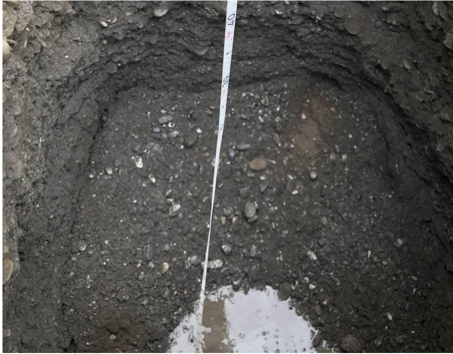
Figura 18 - Rilievo pedologico: falda affiorante a 2,6 m dal piano campagna
