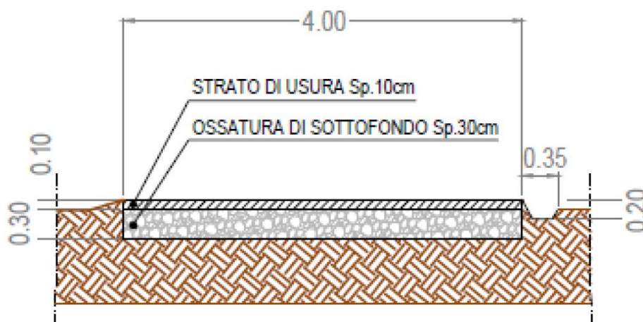
Fig. 3.9 – Dettaglio della viabilità interna all'impianto
